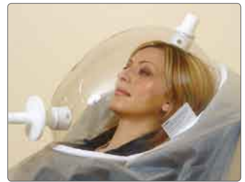
Dépense énergétique au repos mesurée avec un canopy.
